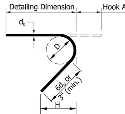
**135° SEISMIC HOOK**
